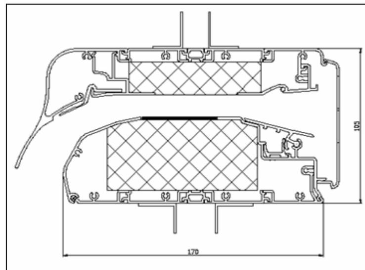
1. Алюминиевый вентиляционный корпус с термоизоляцией
